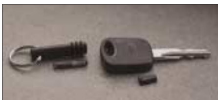
Obr. 2 ExxonMobile a SpeedPass, oba s přiloženými vypreparovanými čipy
