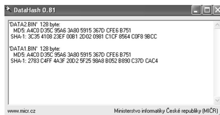
Obr. 1 Memento kolizí hašovací funkce MD5 (ST 12/2004) v jednom z nástrojů elektronického podpisu [3]. Díky kombinaci s funkcí SHA-1 je riziko eliminováno
