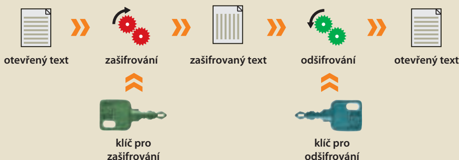
Obr. 1. Základní schéma šifrovacího algoritmu
