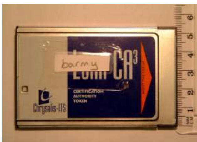
Obr 1. Kryptografický token Chrysalis-ITS Luna CA3
