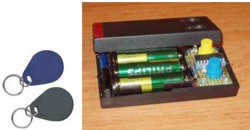
Obrázek 5: Transpondér v podobě klíčenky a zlodějka pro pásmo LF
